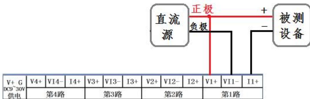
图 5.3、产品接线示意图
