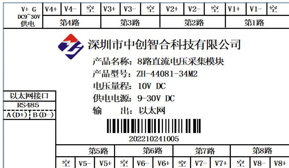
图 5.2、以太网口电压输入产品引脚定义图(带 RS485 口)
