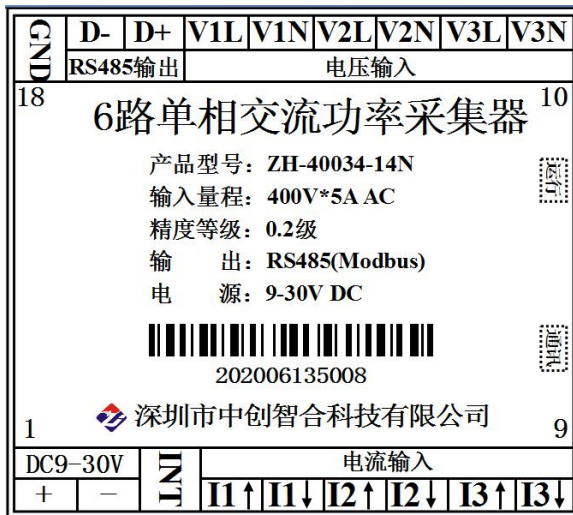
图 5.3 引脚接线定义图（功率测量时电压要与电流通道对应，如 V1 与 I1 为一组通道）
