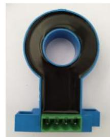
闭环霍尔电流传感器：额定电流 100ARMS、霍尔磁补偿工作原理、可隔离测量 AC、DC、脉冲电流。
