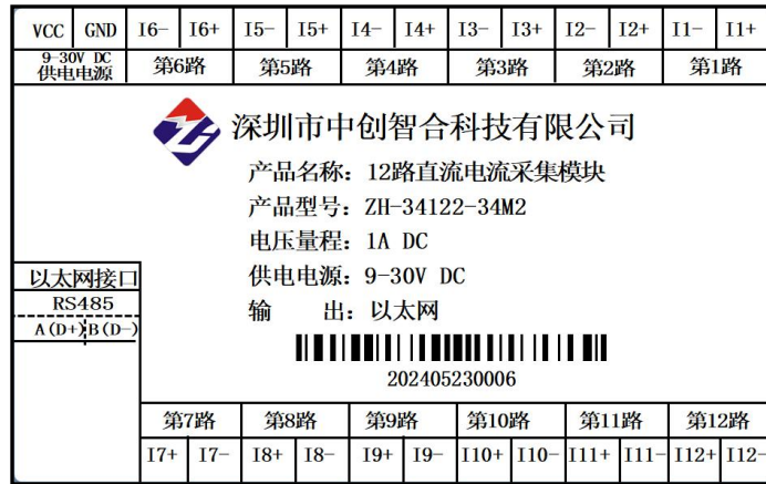
图 5.2、以太网口通讯电流输入引脚定义图(注:以太网不带 RS485 口)
