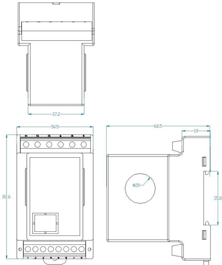
图 4.3、产品外观尺寸图(单位 mm，带底下红色卡扣总长 86mm)
