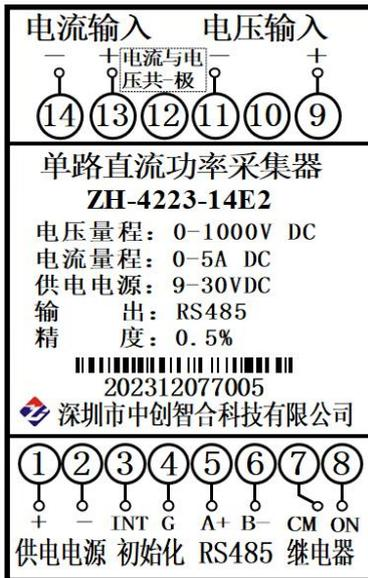
图 5.2、组合型电流端子输入接线图
