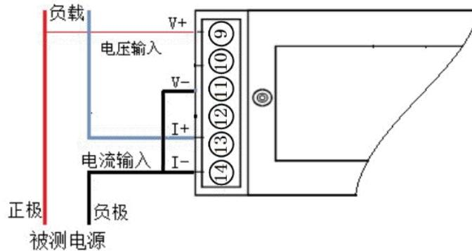
图 5.2、4223 产品电压电流端子输入时产品接线参考图
