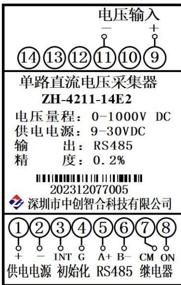
图 5.1、单电压产品接线图
