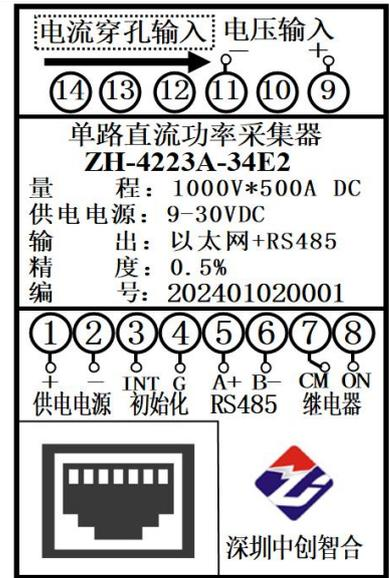
图 5.3、电流穿孔组合型以太网接线图
