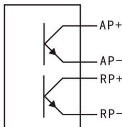
(2) 脉冲常数：3600 imp/kWh，其意义为：当仪表累积1kWh时脉冲输出个数为3600个，需要强调的是1kWh为电能的二次测电能数据，在PT、CT的情况下，相对的3600个脉冲数据对应1次测电能为1kWh×电压变比PT×电流变比CT。
